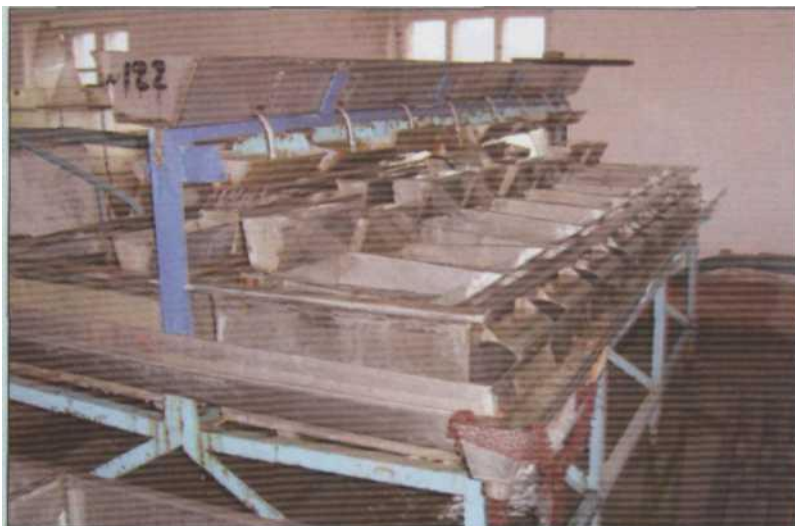
Рис. 59. Апарат "Осетер" для інкубації ікри осетрових риб
