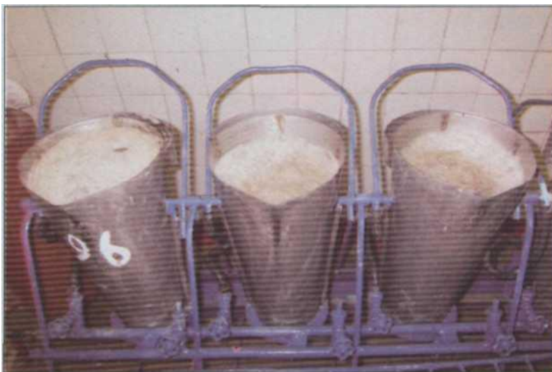
Рис.58. Апарат для знеклеєння ікри осетрових риб
