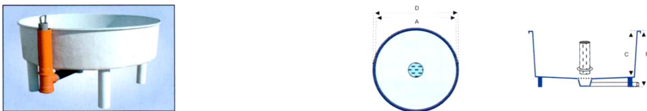
Мал. 48. Круглий басейн на ніжках, з ухилом дна, прийомом для фекалій та стічною трубою
