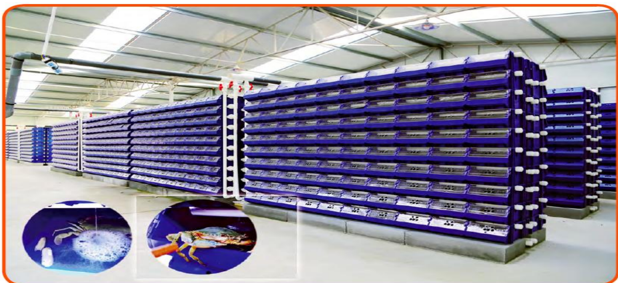
Рис. 42. Рециркуляційна аквакультурна установка по вирощуванню краба
