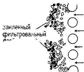
Рис. 2.13. Схематический разрез фильтровального рукава, показан процесс удаления заиленного фильтровального слоя обратной промывкой
