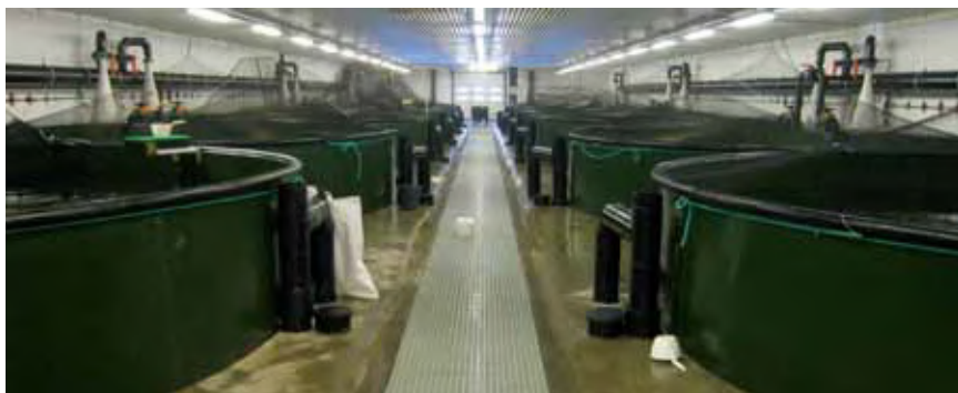
Иллюстрация 1.1 Крытая установка замкнутого водоснабжения.
