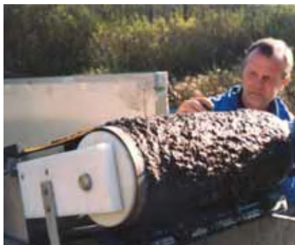
Иллюстрация 6.4 Ленточный фильтр «Hydrotech», используемый для вторичной очистки вод (обезвоживания шлама).
