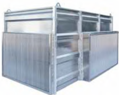
Иллюстрация 2.15 Кислородная платформа для растворения чистого кислорода в воде при низком давлении в процессе её циркуляции по хозяйству. Данная система обычно повышает насыщенность поступающей в рыбководные бассейны воды кислородом до чуть более, чем 100%, в зависимости от скорости циркуляции и планировки хозяйства. Источник: FREA Aquaculture Solutions
