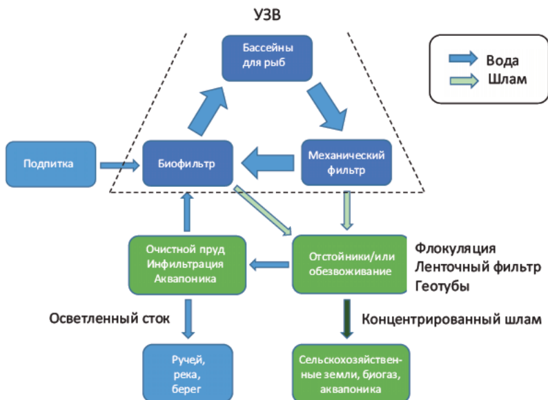
Иллюстрация 6.3 Пути шлама и воды внутри и снаружи УЗВ. Чем выше степень рециркуляции, тем меньше объем покидающей систему воды (пунктирная линия), равно как и объем требующих очистки сточных вод. Источник: Hydrotech.
